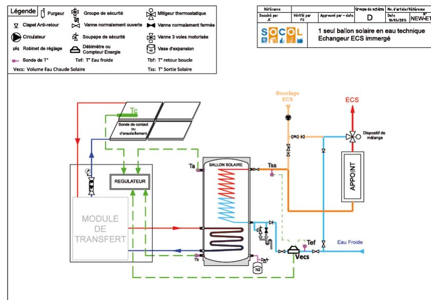
Exemple: Bouclage solaire // Eau technique échangeur ECS immergé
